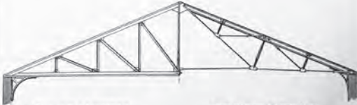
Ferme rigide à 3 contrefiches Spécialité de nos Fermes, toutes sont fabriquées à Nevers-Faumar (40-94-387)
