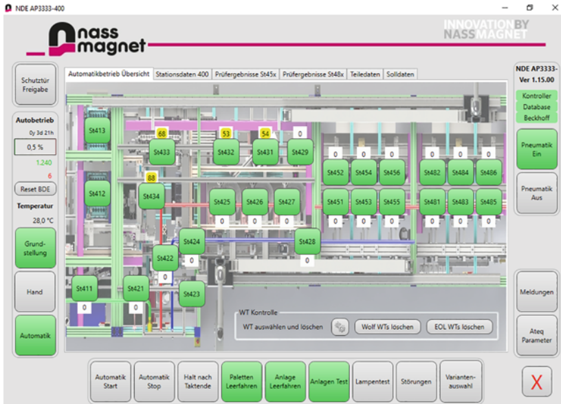
Abb.2 Bedienoberfläche mit Übersicht über Stationen einer Montageanlage. (Bild: nass magnet GmbH)
