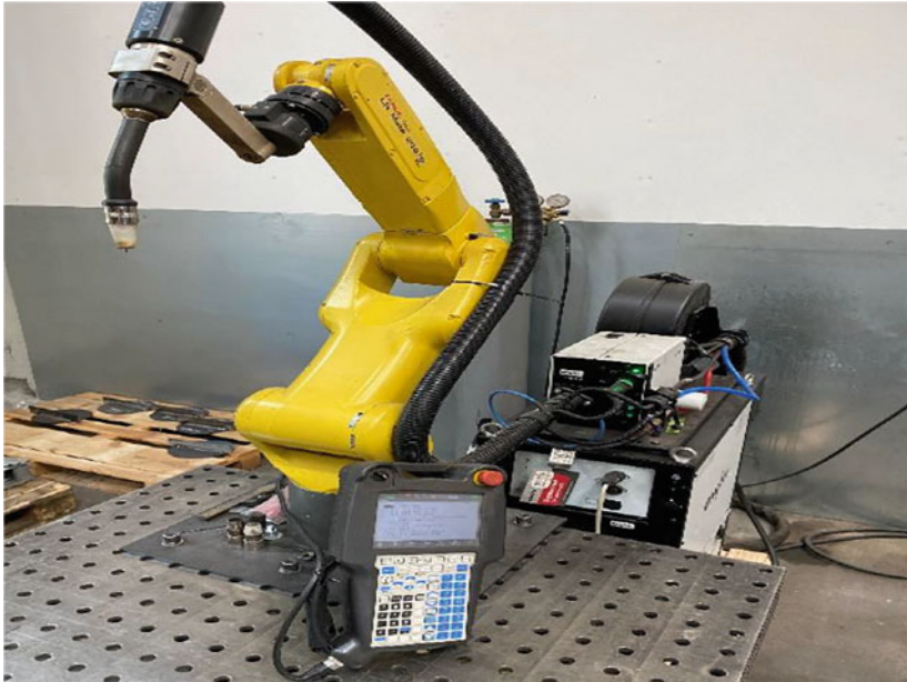
Abb. 4 Schweißroboter, Testgerät. (Foto: René Neumann/SHA GmbH)
