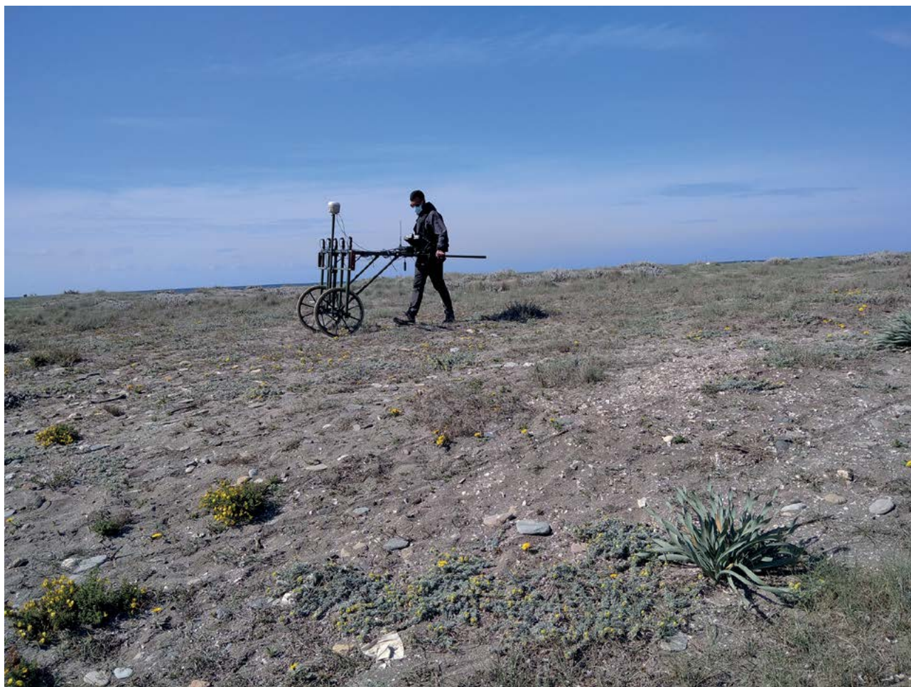
Figura 8.1. Investigador operando el magnetómetro.
