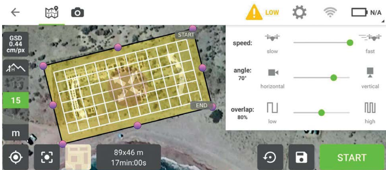
Figura 7.2. Programación del vuelo fotogramétrico desde Pix4Dcapture.
