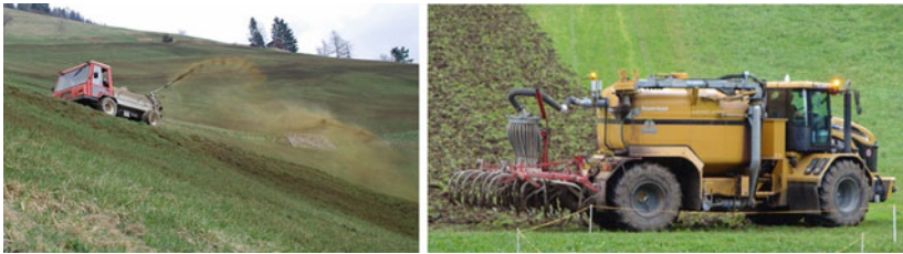
Abbildung 5.3 Herkömmliche Gülleausbringung im Vergleich zur Einbringung mit einem Güllegrubber. (Fotos: Thomas Möllers CC BY-SA 4.0)
