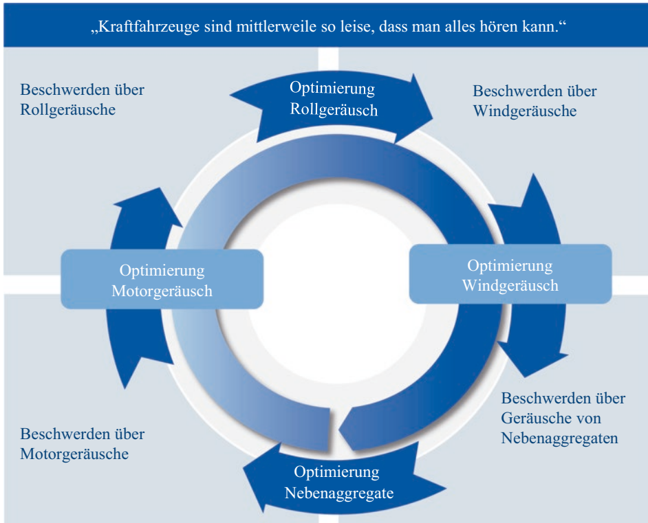
Abb. 21.6 Prozess der Fahrzeuggeräuschoptimierung. (vgl. Kampker et al. 2018, S. 196)
