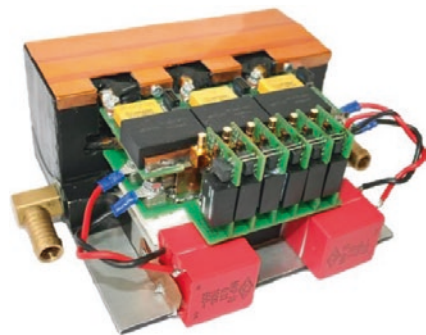
Abb. 10.3 Topologie und Foto eines DC/DC-Wandlers mit SiC-MOSFETs. (Vgl. Sewergin 2021)
