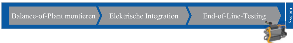
Abb. 16.4 Prozessablauf der System-Montage der Balance-of-Plant
