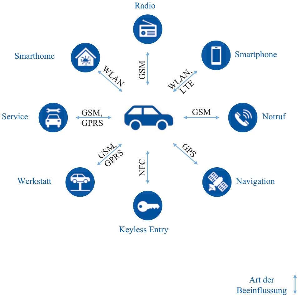
Abb. 21.14 Elektromagnetische Umwelt im Kraftfahrzeug. (vgl. Reif 2011, S. 542f)
