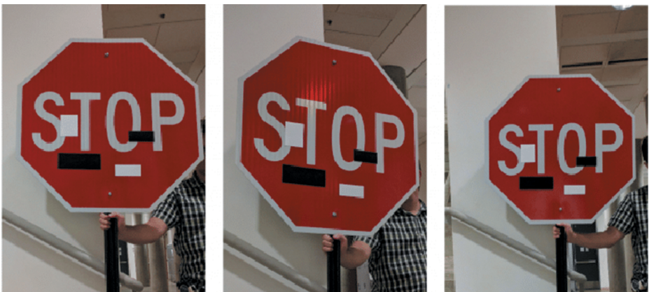
Abb. 7.5: Manipuliertes Stoppschild führt zu Fehlklassifizierung [9].
