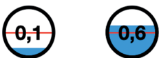
Abb. 3.6: Bei den Ausgabeneuronen wird kontrolliert, ob der Füllstand die Grenze von 0,5 überschreitet (dann steht es für JA) oder nicht (dann steht es für NEIN).
