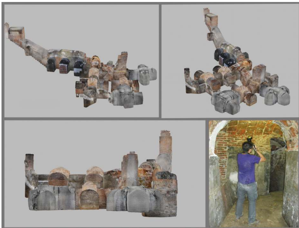
Figura 4. Composición que permite observar algunas vistas de la galería, así como el proceso de obtención del modelo mediante la técnica fotogramétrica. Elaboración propia.
