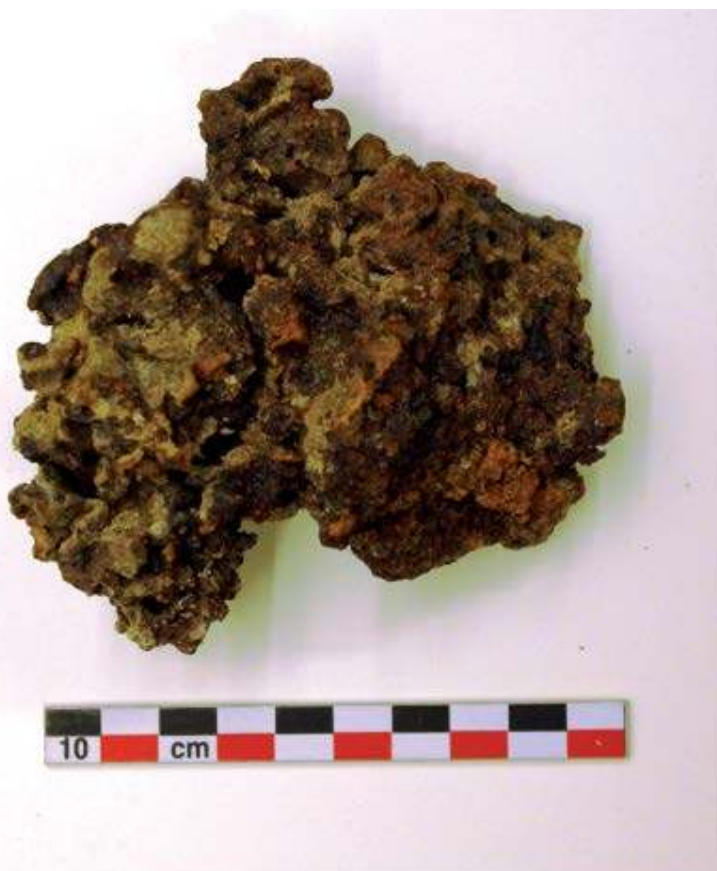
Figure 8. Exemple d'une scorie complète de type SFR 2, issue du silo 1003 (Us.06-5). On distingue de nombreuses empreintes de charbon de bois.
