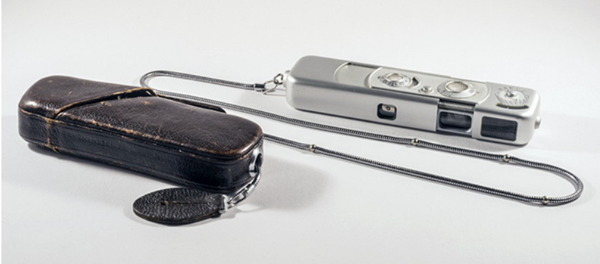
Bild 82 Kleinstbild: 1936 entwickelte und von 1938 bis 2012 fast unverändert produzierte Spionagekamera Minox 8 x 11 mm , hier als Modell B, hergestellt um 1962, Foto: Anonym, 2016.
