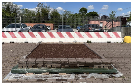
Fig. 5 – Lo strato colturale è costituito da una miscela prevalentemente minerale di zeolite con 3% di sostanza organica
