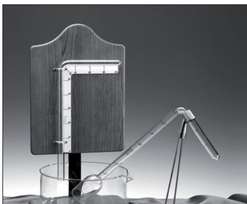
Fig. 20 – Ricostruzione dell'eudiometro di Giobert (a sinistra) e della versione realizzata da Spallanzani (a destra). I dispositivi sono stati riprodotti da R. Lodesani, I. Tegoni e E. Bondavalli in occasione della mostra "Spallanzani e la respirabilità dell'aria nel tardo '700. Strumenti e misure della chimica pneumatica" (Scandiano, 1998). L'immagine è tratta dal catalogo edito a cura di Fabrizia Capuano e Bruno Cavalchi (Scandiano, Casa Spallanzani, 1998, p. 71)
