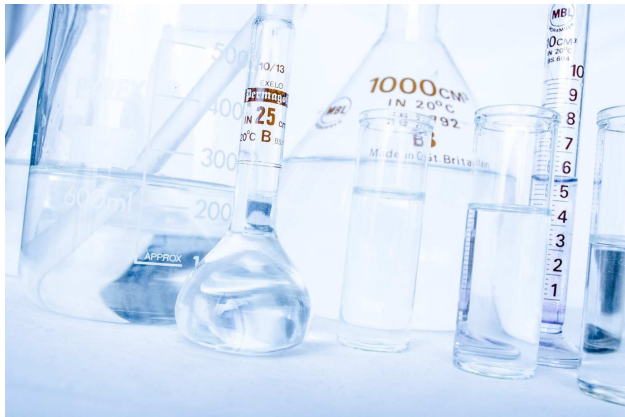
FIGURE 5. Verre dans un laboratoire de chimiste : le verre résiste à énormément de produits chimiques. Cette propriété, combinée avec la facilité de sa mise en forme pour réaliser de nombreux dispositifs, en fait le matériau par excellence utilisé dans tous les laboratoires de chimie.
