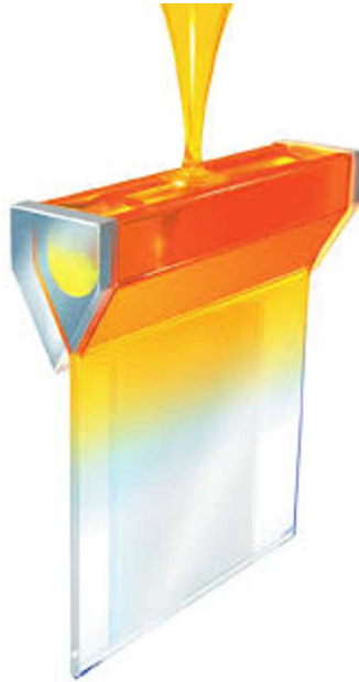
FIGURE 58. Schéma du procédé de « Fusion Draw ». Ce procédé permet en déversant du verre fondu dans la gorge d'une poutre réfractaire de préparer une feuille de verre très mince. Du fait de la géométrie de la poutre, le verre ayant été en contact avec le réfractaire se retrouve à l'intérieur et les deux surfaces extérieures de la feuille de verre restent en contact uniquement avec l'air et sont donc : « polies au feu ». On prépare comme cela le verre très mince des téléphones portables. © Corning Incorporated.
