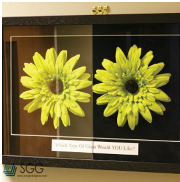
FIGURE 28. Effet antireflet par traitement de la couche extérieure d'un vitrage. Cet effet est obtenu par le dépôt de couches de surface ayant un indice de réfraction intermédiaire entre l'air et le verre. © DR.
