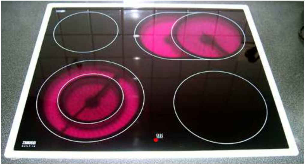
FIGURE 6. Plaque de vitrocéramique : ce verre très spécial résiste aux changements de température par la cristallisation partielle du verre. Elle permet d'avoir un matériau qui ne change pas de dimension avec la température grâce à la compensation de la contraction des nanocristaux avec la chaleur par la dilatation de la matrice en verre qui les entoure.
