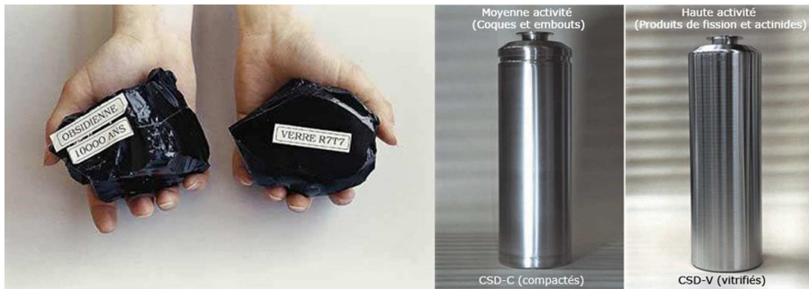
FIGURE 9. Des déchets nucléaires ultimes dissous dans du verre en vue de leur enfouissement. Le verre est un très bon solvant permettant de dissoudre bien des composés, en particulier des ions minéraux. Ceci est illustré par la dissolution de déchets nucléaires dans du verre avant l'encapsulation dans un récipient en acier, préalable à l'enfouissement. © DR.
