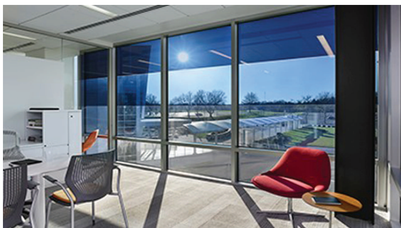
FIGURE 34. Illustration de l'effet électrochrome. Par un simple contrôle électrique, on peut passer d'un vitrage transparent à un vitrage foncé permettant de réguler la quantité de lumière entrant dans une pièce. © DR / Archives de Saint-Gobain.
