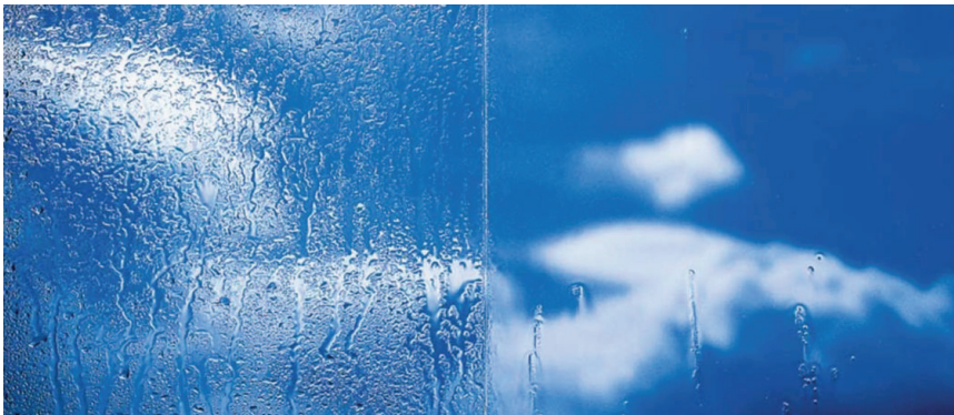
FIGURE 31. Effet autonettoyant d'un vitrage. Une mince couche d'oxyde de titane déposée à l'extérieur d'un vitrage permet de garder l'hydrophilicité du verre en oxydant par catalyse et sous l'action des UV les salissures d'origine organique. De ce fait, au lieu de gouttes d'eau s'accrochant au vitrage, la pluie constitue un film continu gardant ainsi la vitre propre. © DR / Archives de Saint-Gobain.
