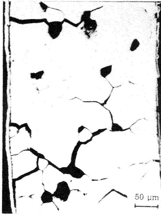
Figure 3. Corrosion d'un manchon d'assemblage combustible en acier AISI 304 L après stockage en piscine de désactivation [2].
