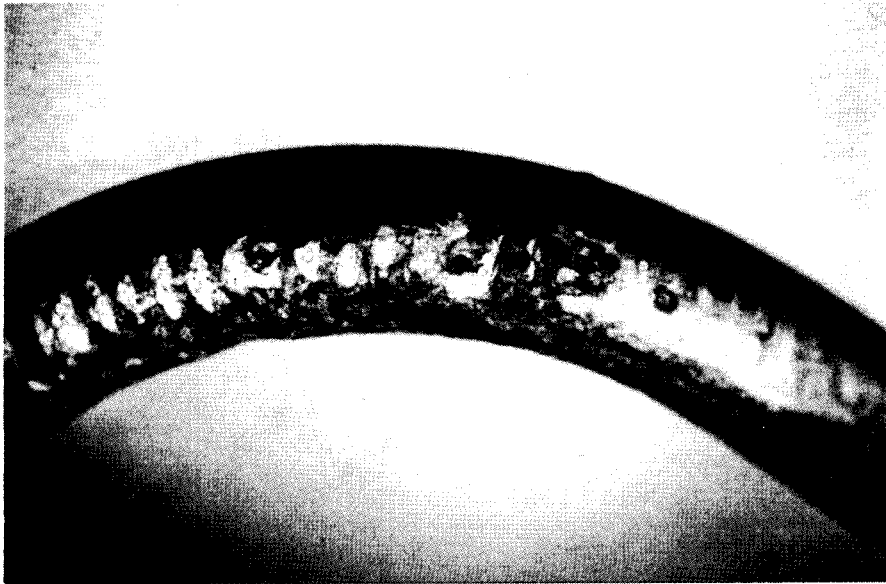
Planche 1. Corrosion cavernouse du cuivre sous gaine isolante en plastique.
