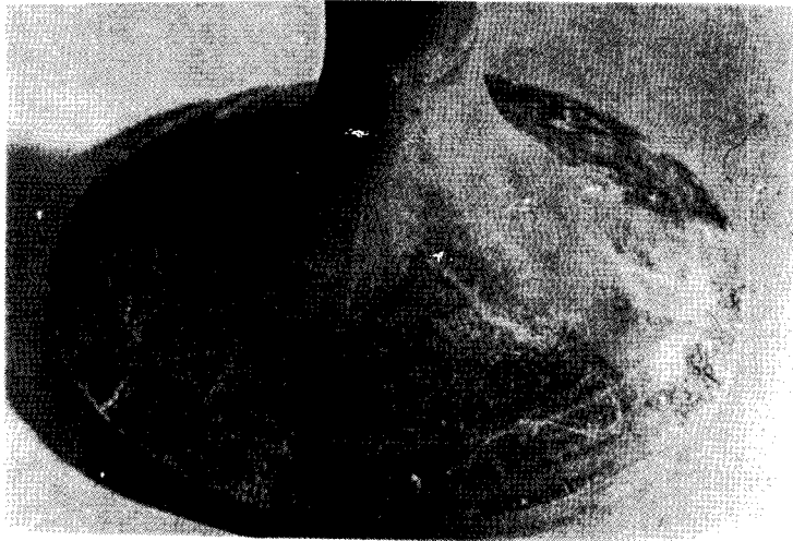
Figure 8. Corrosion en gouttière sur une soupape de moteur diesel
