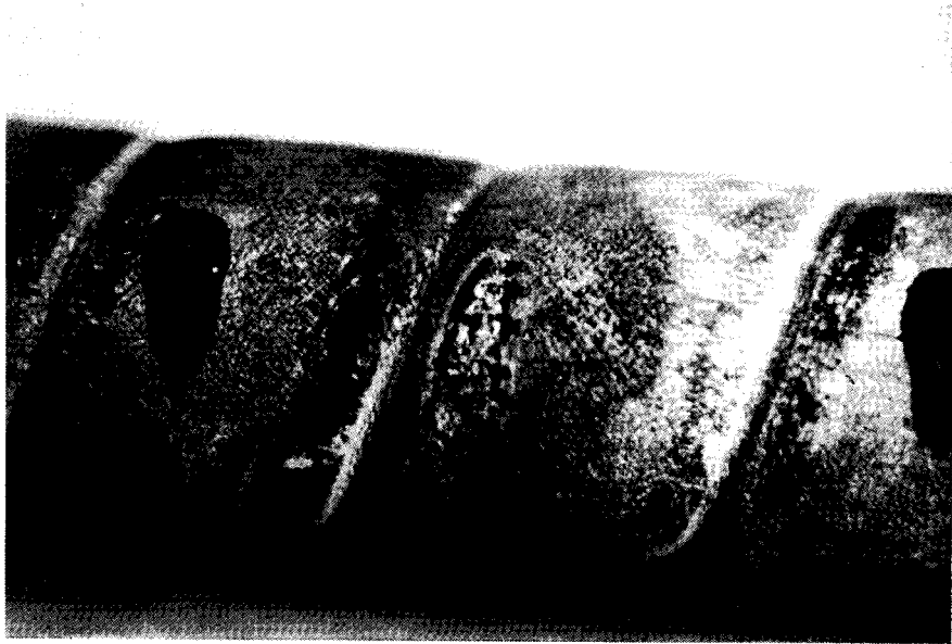
Planche 4. Corrosion cavernueuse aux zones de contact chicane acier/tube cuivre ; échangeur Eau/Fréon.
