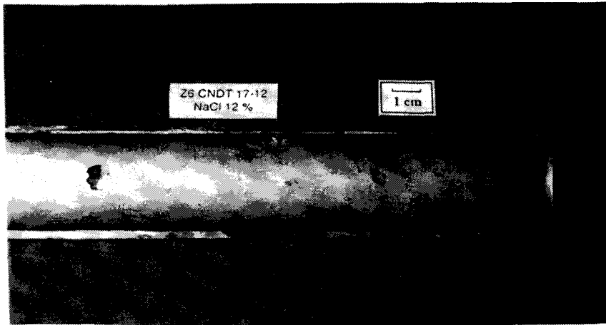
Figure 8. Matériau: Z6CNDT 17-12 - Matériel: Élément de tuyauterie (DN 50) - Milieu: Solution de NaCl 12 % à pH 3 et à 80 °C. Pilote discontinu - Observations: Présence de 2 grosses piqûres vraisemblablement initiées pendant les arrêts..
