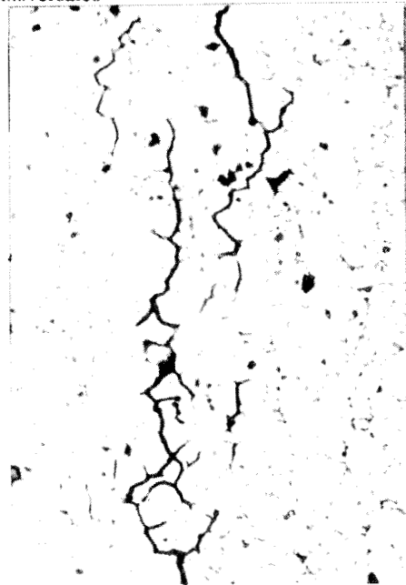
Figure 13. Corrosion intergranulaire sur alliage 5056 A (tuyauterie conduisant l'air à 90 °C)
