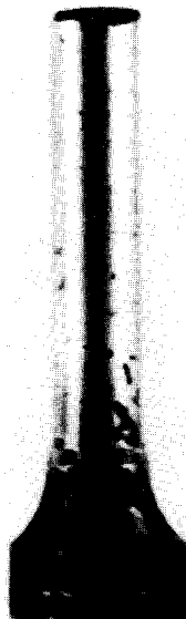
Figure 1 Exemple de corrosion par piqûres d'un acier faiblement allié. Acier 35NCD16 (Ni-Cr) préalablement passivé en milieu \text{NaNO}_2 et piqué par ajout de \text{NaCl} . (D'après travaux IRSID).
