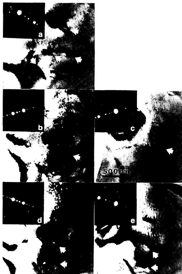
Fig. 5.14. Images en champ clair d'une lame mince de monocristal i\text{-Al}_{70}\text{Pd}_{21}\text{Mn}_9 contenant des dislocations (en face des flèches blanches). En (a), ces dislocations sont visibles mais elles s'effacent en (b) et (c) car la condition d'extinction forte est satisfaite par le choix des vecteurs de diffraction respectifs (voir le texte). De même, un autre choix de vecteur de diffraction conduit à l'extinction faible comme en (d) et (e) (permission de K. Urban, Jülich, tous droits réservés).
