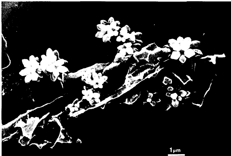
Fig. 3.1. Bouquet de quasicristaux formés dans un alliage assez pauvre en manganèse ( \text{Al}_{17}\text{Mn} ). La matrice d'aluminium au sein de laquelle les fleurs ont poussé a été retirée par dissolution électrolytique. Il n'en subsiste qu'un fragment qui constitue la branche. L'observation est effectuée au microscope électronique à balayage avec le grossissement indiqué par la barre blanche en bas de l'image (permission de H.U. Nissen et al. , Philos. Mag. B 57 (Taylor and Francis, 1988) p. 587).
