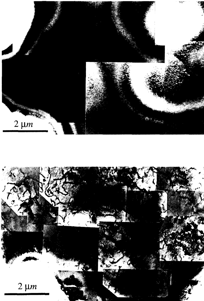
Fig. 5.13. Observation par microscopie électronique en champ clair de la multiplication des dislocations dans un monocristal icosaédrique Al_{70}Pd_{21}Mn_9 déformé plastiquement à 750 °C. L'image du haut a été prise avec un échantillon chauffé à 750 °C mais n'ayant subi aucune déformation. Seules quelques rares dislocations sont visibles. L'image du bas vient d'un échantillon après 25 % de déformation. Les dislocations sont extrêmement nombreuses et sont réparties de façon homogène dans toute la zone étudiée (plusieurs micrographies sont assemblées pour couvrir un plus grand champ d'observation) (permission de K. Urban, Jülich, tous droits réservés).
