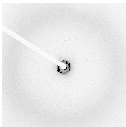
Figure 3.22 Cliché de diffraction de la phase cubique de l'acide p-hexadécyloxy-nitro-3-phényl-4-benzoïque.
