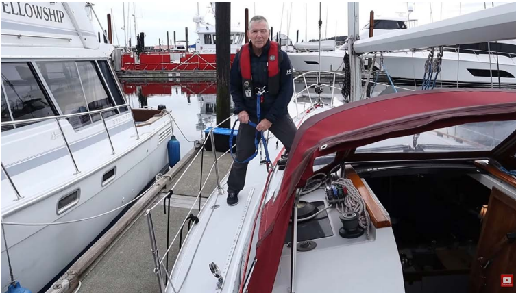
[Abb. 2] Sorgleine mit Gurtgeschirr und Strecktau (Quelle: Carpe Diem Sailing. 2021. „Safety at Sea, Ep. 45: Harnesses, Tethers.“ Videotutorial, 00:17:26. Youtube.com . Zugriff 5. Dezember 2022. https://www.youtube.com/watch?v=C7vqMNynlp0 )
