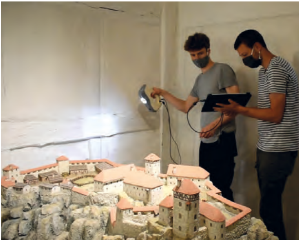
Abb. 3: Teilnehmer erfassen das Styropor-Modell der Burg mit dem Artec Eva 3D-Scanner [Hess 2020].
