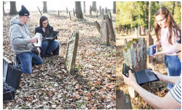
Abb. 5: Handscanner mit strukturiertem Licht: Artec EVA (links) und Artec Spider (rechts) [Hess 2019].
