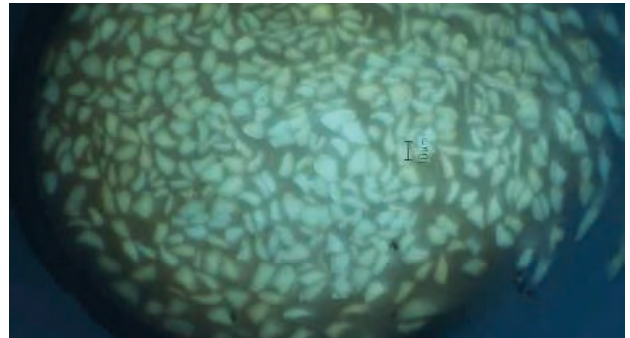
Querschliff: Unter UV-Anregung ist die starke Fluoreszenz der Seidenfasern zu erkennen. Der dreieckige Querschnitt lässt auf eine Bombyx-Seide schließen.
