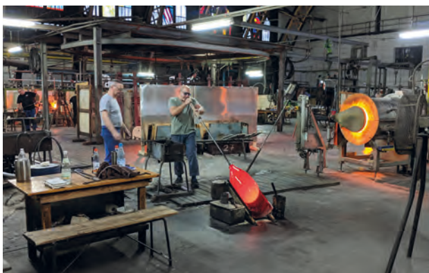
Abb. 2: Zylinderglasproduktion nach historischem Vorbild bei der Firma Lamberts in Waldsassen [Bellendorf 2018].
