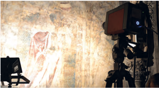
Abb. 1: Messaufbau für aktive Thermographie: IR-Detektor (Spektralbereich 2.0 ... 5.7µm, filterlos) und Anregungsquellen (Halogenstrahler 500W) [Tenschert 2019].
