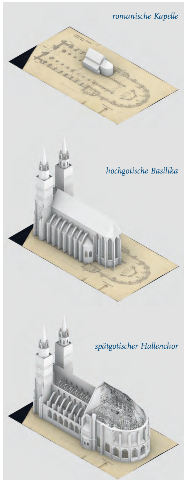
Abb. 4: Die Aufgliederung des Modells in verschiedene Kontexte, erlaubt die Referenzierung nutzerspezifischer Informationen und die Zusammenstellung fachspezifischer Darstellungen. Hier ermöglicht die entwicklungsgeschichtliche Separation die Abbildung verschiedener Bauzustände von drei ausgewählten Zeitpunkten [Nöbauer / Luib 2018].
