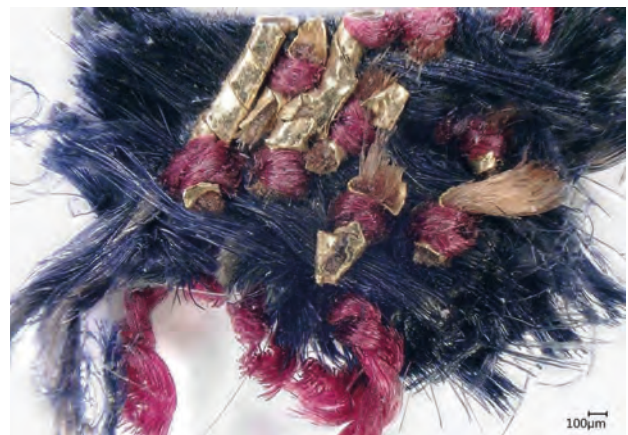
Gewebestück: Mit Indigo gefärbter originaler Trägerstoff, auf den mit Hilfe roter Haltefäden Goldlahn gestickt ist (3D-Digitalmikroskopie)
