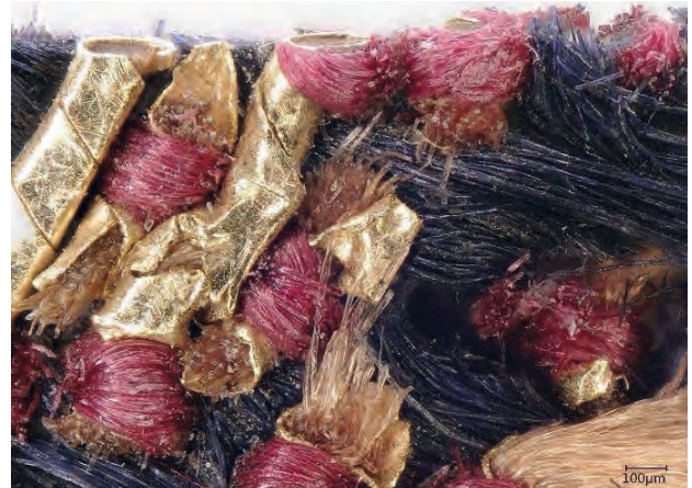
Der Goldfaden wird angelegt und nur durch den roten Haltefaden aus Seide auf dem Trägergewebe fixiert. 3D-Mikroskop
