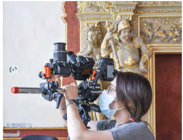
Abb. 7: Die Gastwissenschaftlerin Nicoletta Campofiorito überprüft den Bildausschnitt an einer der drei digitalen Spiegelreflexkameras auf dem Kamerawagen vor dem Kamin. Im Hintergrund ist eine kodierte Zielmarke an der Wand zu sehen. [Mona Hess 2020].
