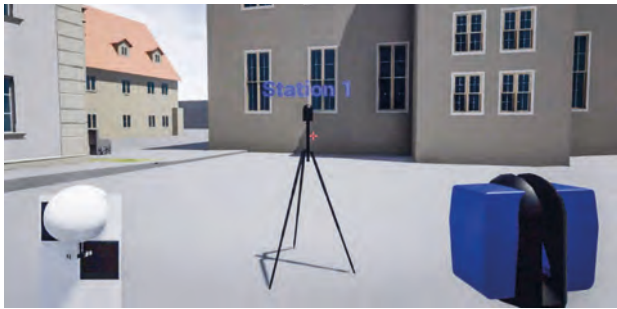
Abb. 4: Grafische Simulation des Scanvorgangs [Chizhova et al. 2020].
