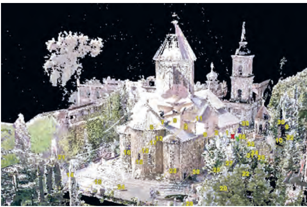
Abb. 3: oben – Sioni-Punktwolken von beiden Drohnenflügen; unten – Sioni-Punktwolken erstellt mit terrestrischen Laserscannern Leica BLK (links) und FARO Focus 3D (rechts) [Luhmann et al. 2019].
