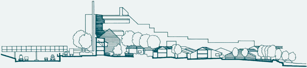
Coupe exprimant le dispositif d'enclos assumé par le bâtiment le plus haut et confronté à l'infrastructure, dans le projet Byker Wall de Ralph Erskine à Newcastle. Source: ERSKINE [1968].
