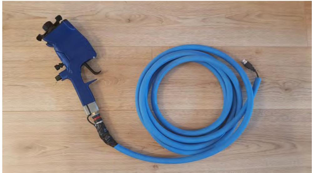
**Abb. 2:** 3D-Druck einer nachgebauten Lackierpistole mit Druckschlauch.
