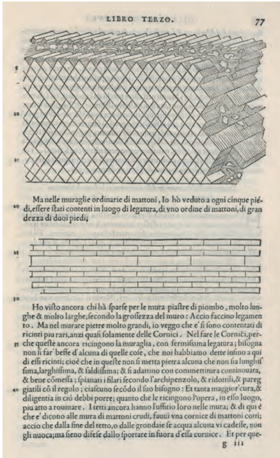
FIGURE 11.5 Cosimo Bartoli (inventor), Opus reticulatum and opus quadratum . Woodcut, c.1550. From: Leon Battista Alberti, L'ARCHITETTURA DI LEONBATISTA ALBERTI. Tradotta in lingua Fiorentino da Cosimo Bartoli Gentil'huomo & Accademico Fiorentino. Con la aggiunta de Disegni. , trans. Cosimo Bartoli (Florence, Lorenzo Torrentino: 1550), Zurich, ETH-Bibliothek Zürich, Rar 9906, 77. https://doi.org/10.3931/e-rara-770 PUBLIC DOMAIN
