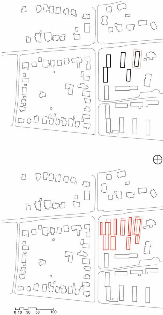
Abb. 41: Lagepläne Bestand – Nachverdichtung, Bergedorf
