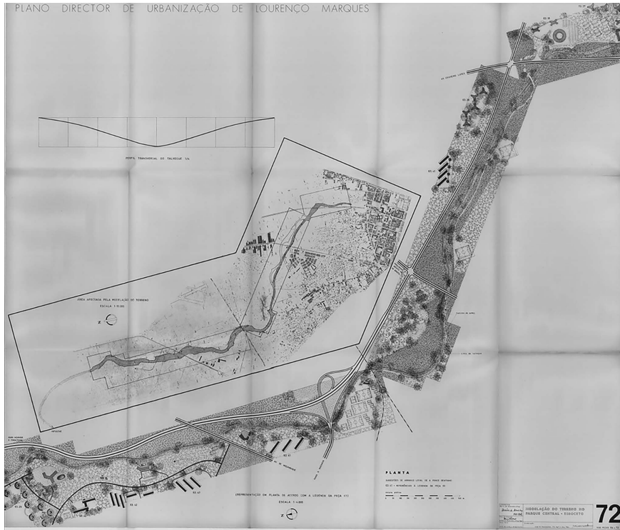
Figure 12.1 Central Park Grading Plan (Modelação do Terreno do Parque Central), Plano Director da Cidade de Lourenço Marques (Azevedo et al., 1969).
