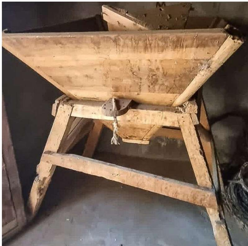
*Figura 3:* Tolva del molino hidráulico harinero. Písquera *Bou Barroeta*, Huasco. Foto: RB.
