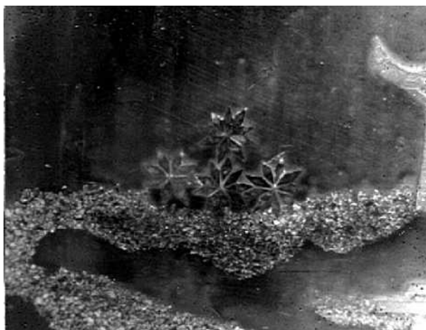
Εικόνα 7α Φωτογραφία στο υπέρυθρο φάσμα με την κάμερα υπέρυθρου ως 1100 nm, διαπιστώθηκαν ίχνη από τη μέθοδο στίλβωσης της λάκας.
