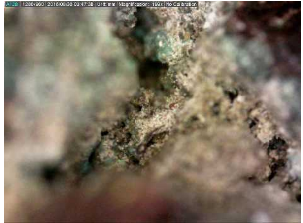
Εικόνα 8. Υπολείμματα ασβεστίου και εμφάνιση χαρακτηριστικού πορώδους που προκαλείται από αέρια κατά την διαδικασία της τήξης (κατάλοιπο χύτευσης KYT_AYV_BW_04).
