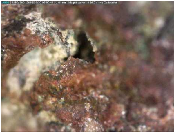
Εικόνα 5. Ασβεστιτικά συσσωματώματα παγιδευμένα σε μεγάλες οπές (κατάλοιπο χύτευσης KYT_AYV_BW_17).
