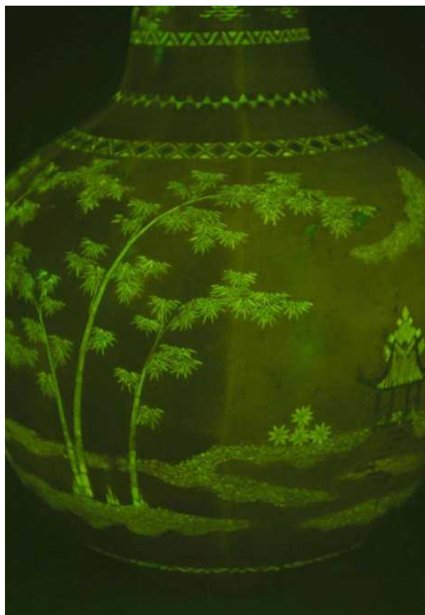
Εικόνα 8 Φωτογραφία στο υπεριώδες φάσμα, περιοχή με ρητίνη μεταγενέστερης επέμβασης παρουσιάζει διακριτό φθορισμό.
