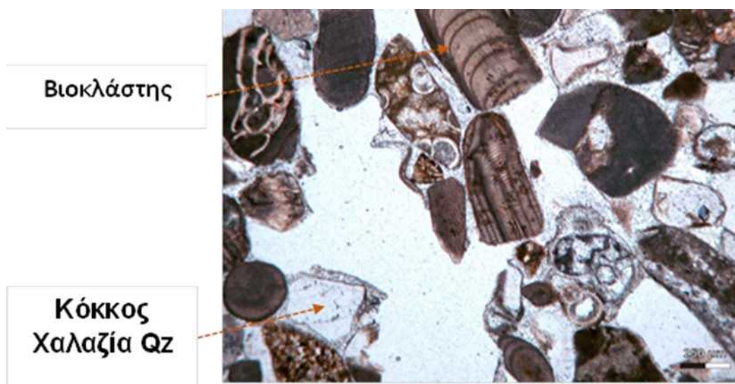
Εικόνα 9. Μικροσκοπική παρατήρηση εξεταζόμενου δομικού λίθου, N//, μέγιστη διάσταση φωτογραφίας 0,25mm
