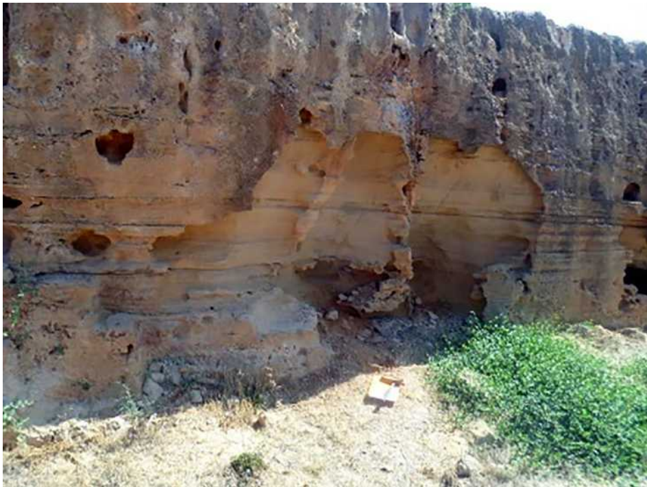
Εικόνα 6. Κυψελοειδής φθορά λόγω ανέμων οι οποίοι μεταφέρουν σταγονίδια με υψηλή περιεκτικότητα σε άλατα Λατομείο 3
