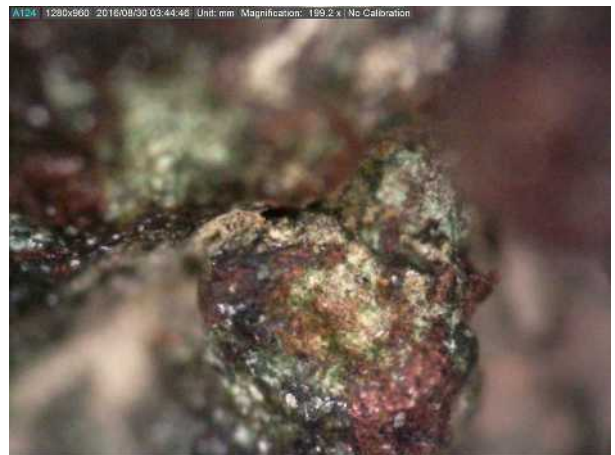
Εικόνα 9. Οξειδία του χαλκού και διαβρωμένα σφαιρίδια χαλκού (κατάλοιπο χύτευσης KYT_AYV_BW_04).
