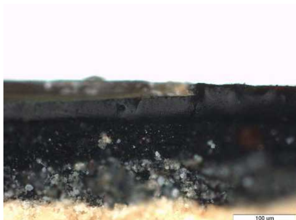
Εικόνα 5 Εγκάρσια τομή του δείγματος της διακόσμησης στο πολωτικό μικροσκόπιο, διακρίνεται ότι τα διακοσμητικά φύλλα είναι εγκιβωτισμένα στο στρώμα λάκας.
