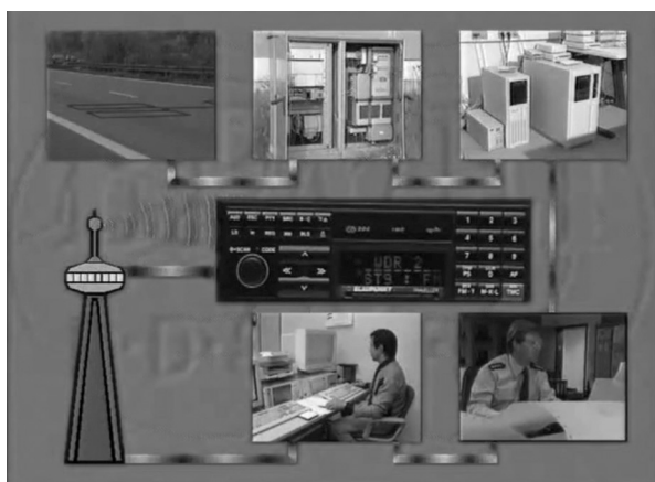
Abbildung 2: TMC-Meldungsfluss im Projekt „BEVEI“ mit Detektion durch Induktionsschleifen in der Fahrbahn sowie Datenübertragungen von Straßen- über Polizei-Behörden zur Rundfunkanstalt, die ebenfalls auf der Codierung von Events und Locations beruhen (Screenshot aus WDR-PR-Film zum Projekt von 1994).
