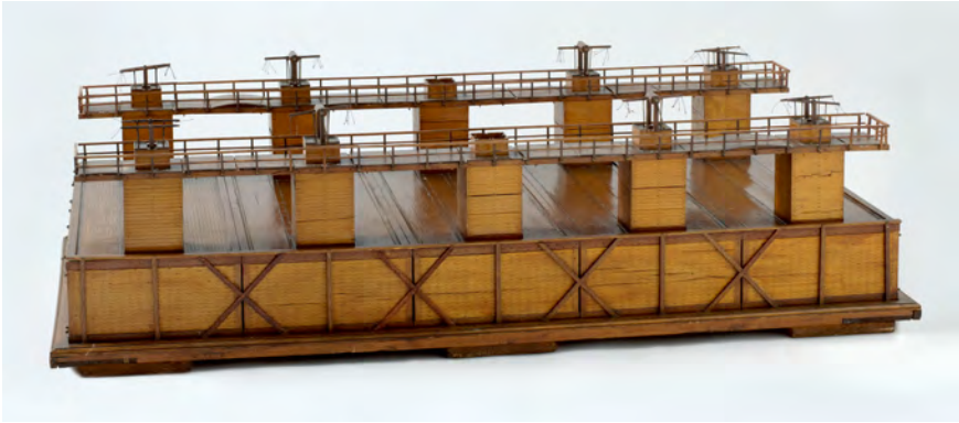
Abb. 11: Modell des Schwimmdocks. Die fünf Sektionen mit den getrennten Pumpen auf paarweise angeordneten turmartigen Aufbauten sind gut erkennbar. (Rijksmuseum Amsterdam, Inv.-Nr. NG-MC-6)
