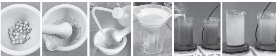
Abb. 5: Ablauf des Modellexperiments zur Wasseraufreinigung mit Moringa-Samen
