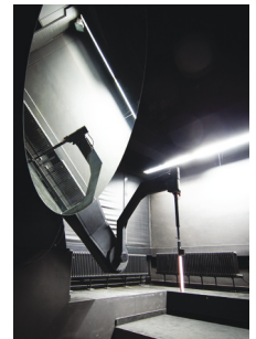
Filtermonochromator/kleine Kennzahlkugel/Drehspiegelgoniophotometer | Monochromator/small Integrating sphere/mirror goniophotometer. Quelle | Source: TU Berlin/FG Lichttechnik
