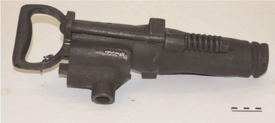
**Abb. 3:** Bohrhammer aus der Sammlung des DBM. Die Inventarnummer ist auf Klarlack geschrieben. Die alte, direkt auf das Metall aufgebrachte Inventarnummer ist stark verblasst erkennbar.
