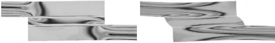
Abb. 2.11: Spannungsverteilung einer einschittig überlapptem Klebung mit verformungsarmem Epoxidharz (links) und elastischem 1K-PUR (rechts) - Computersimulation nach [60]
