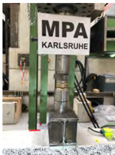
(b) Lasteinleitung Drei-Punkt-Biegeversuch
