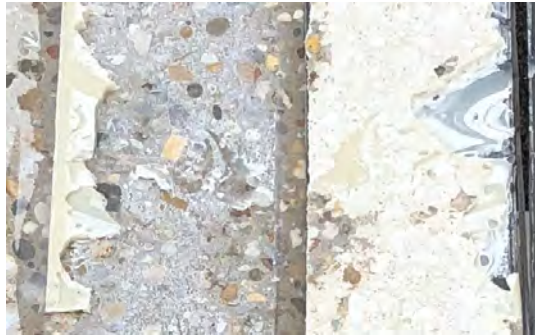
Abb. 6.26: Blasen- und Schlierenbildung durch Lufteinschlüsse eingetragene durch händischen Mischvorgang
