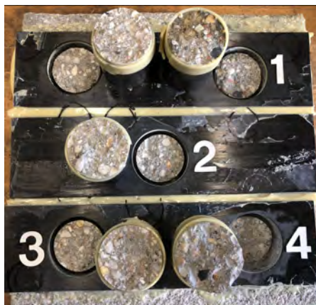
Abb. 6.11: Bruchbild - Haftzuguntersuchungen low-cycle fatigue am applizierten Verstärkungssystem
