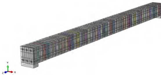
Abb. 5.18: Modellierter Stahlbetonbalken mit Stellen möglicher Rissbildung (farbig) [83]
