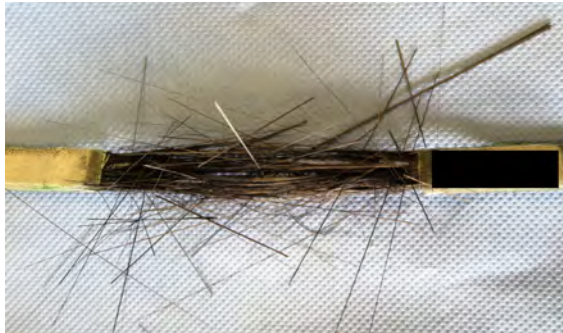
Abb. 6.6: charakteristisches Versagensbild CFK-Laminat
