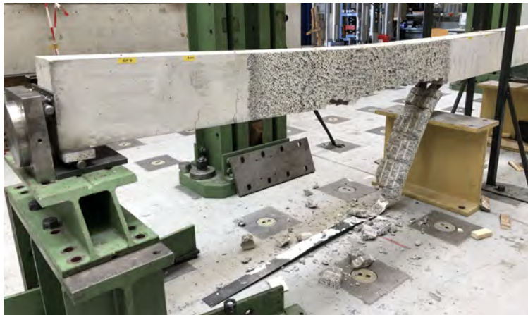
Abb. 6.57: Kohäsionsbruch im Beton bei B01-K4e-B19-C1
