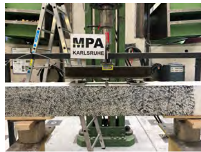
(c) Lasteinleitung Vier-Punkt-Biegeversuch
