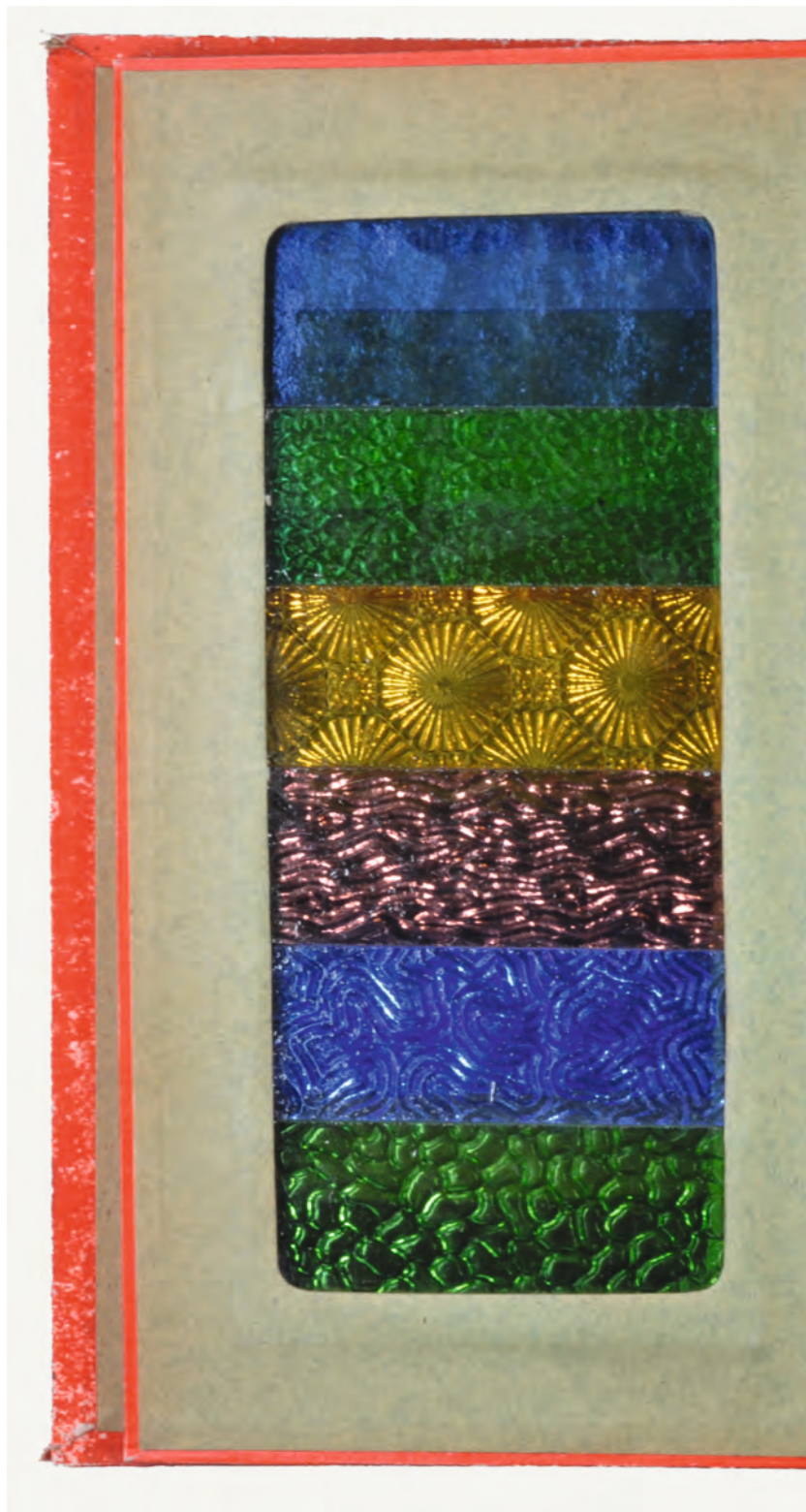
7 Verrerie de Saint Gobain et de Jeumont, Album des principaux modèles de verre: Produits spéciaux en verre coulé, around 1915–20, samples of rolled plate glass, cardboard, 28.4 × 17.7 × 8 cm, collection of the Vitromusée Romont (VMR 738).
