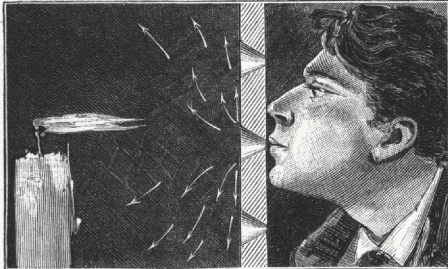
Fig. 3. — Effet produit sur une flamme de bougie en soufflant par la petite base de l'orifice conique d'une vitre perforée.
