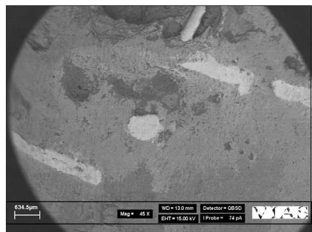
Abb. 11: BSE-Bild. Mit Silber und Kupfer tauschierte eiserne Gürtelschnalle. Durch Korrosion und Restauration selbst unter dem Lichtmikroskop kaum zu erkennen.
