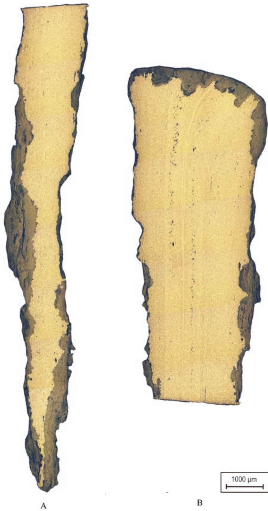
Tafel 12: Mannersdorf/Lgb. – Flur Reinthal Süd, Messer Fnr. 145/2, Ätzung mit Nital, A: Schneide, B: Rücken.
