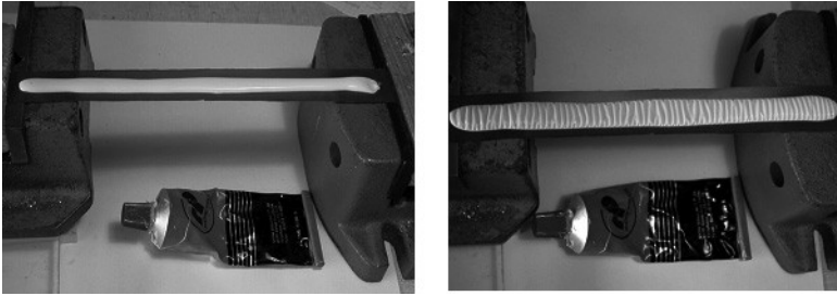
Figure 4.8. Flambage d'un rail de colle sur un élastique tendu. À gauche avant de relâcher l'élastique. À droite, juste après. (Feuille de caoutchouc Tera-band, colle silicone CAF 4, temps de durcissement 30 minutes, allongement 30 %). (Photos Vincent Fleury).
