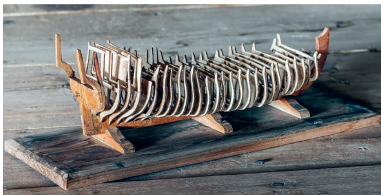
Fig. 5.3. Spantmodellen hör ihop med ritningen 5.2. Den kan tas isär så att varje spant kan studeras för sig (LSH inventarienummer 6921).
