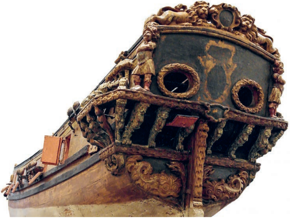
Fig. 7.18. Även om det är ett mindre fartyg, som dessutom byggts om till brännare, så ger modellen Ö 24 en ganska bra bild av färgsättningen på ett svenskt skepp under Karl XI:s tid. Sidorna är ockragula, berghulten svarta, akterspegeln blå och skulpturerna polykroma. Foto: Niklas Eriksson.
