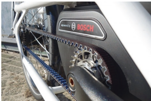
Abb. 1.9 Ein Mittelmotor von der Marke Bosch in einem Urban Arrow
