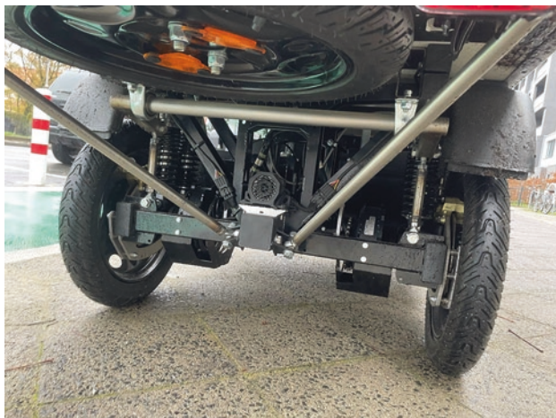
Abb. 1.10 Zwei Nabenmotoren angebunden als Radmotoren in einem mehrspurigen Lastenrad
