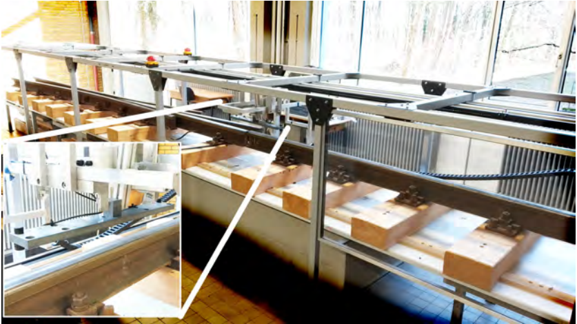
Abbildung 3.4: Darstellung des Schienenprüfstandes zusammen mit einer Detailansicht des DIS.
