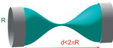
**Abb. 6.56:** Eine stabile Wasserbrücke zwischen zwei Kapillaren.
