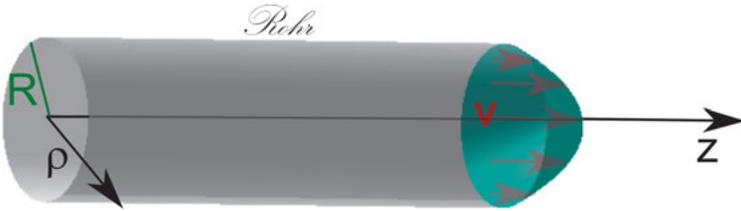
Abb. 6.24: Eine Flüssigkeit wird durch ein Rohr entlang der  $z$ -Richtung gepresst.
