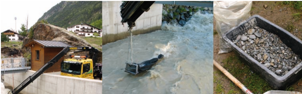
Abb. 20: Geschiebemessung mit einem mobilen Geschiebefänger (a, b) und die erschotete Geschiebeprobe (c) am Pegel Vent/Rofenache (Fotos: Hugo Seitz, Institut für Wasserwirtschaft, Hydrologie und Konstruktiven Wasserbau, IWW, an der BOKU/Wien)
