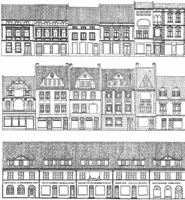
Abb. 42 »Bischofsburg. Häuserreihe an der Nordostseite des Marktplatzes«. 1. Reihe: 1914; 2. Reihe: »Nach den ersten Entwürfen für ihre Wiederherstellung«; 3. Reihe: »Nach dem Wiederaufbau« nach Heimatschutzprinzipien
