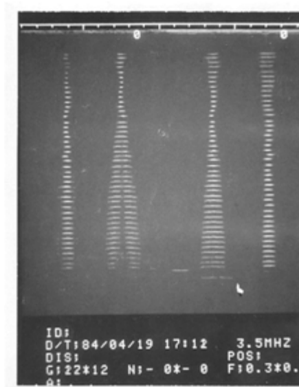
Fascio ultrasonico a focalizzazione dinamica (a sinistra) vs esempi di fasci a fuoco singolo.
