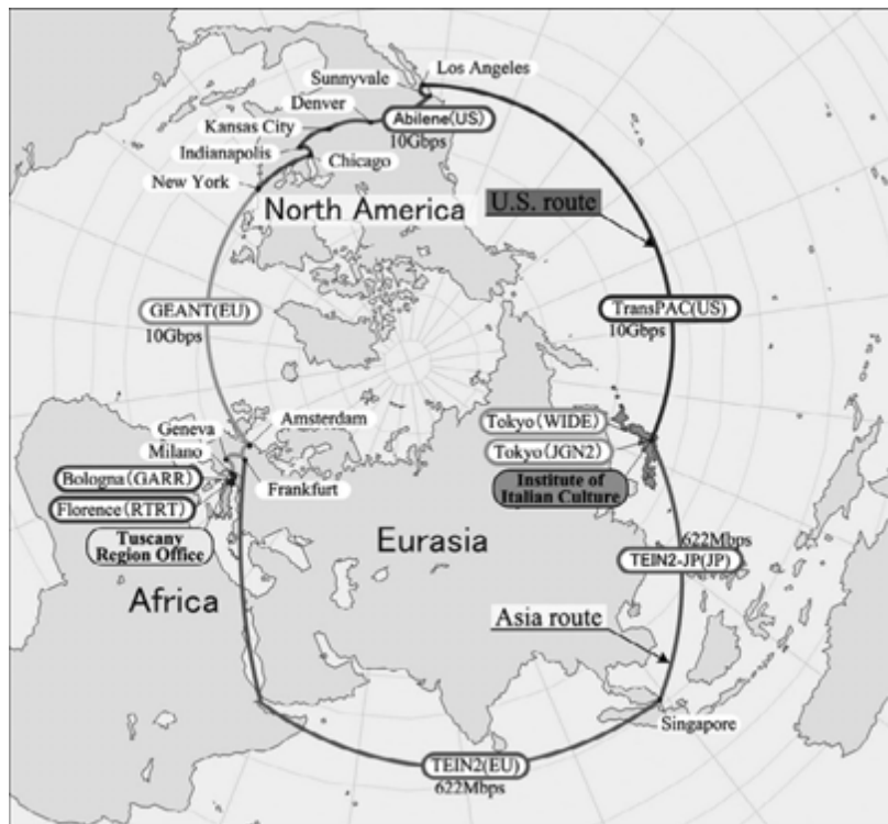
Infrastruttura delle reti di collegamento a larga banda a fibra ottica (una via nord, l'altra via sud) fra Firenze e Tokyo del 16-17 Aprile 2007.
