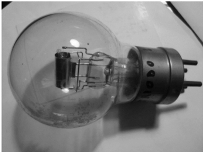
Tubo a vuoto Philips 'Tipo E' col quale Nello Carrara produsse per la prima volta le 'microonde' conservato presso il Dipartimento di Ingegneria dell'Informazione della Scuola di Ingegneria dell'Università di Firenze
