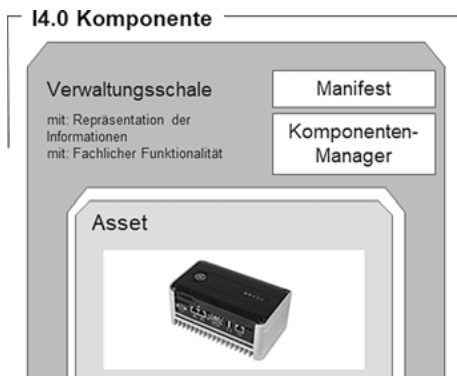
Abb. 4.2: Industrie-4.0-Komponente als notwendige Verbindung von Asset und Verwaltungsschale (Quelle: DIN SPEC 91345 (2016)).
