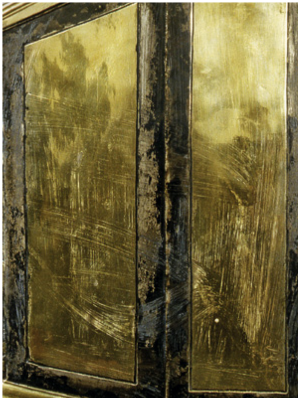
Abb. 24: Beispiel eines gealterten Überzugs aus dem Jahr 1956 auf z. T. feuervergoldetem Silber; Augsburger Silberrelief des frühen 17. Jahrhunderts, Bayerisches Nationalmuseum, Inventar 30/1079; Größe des Bildausschnitts ca. 34 x 20 cm, Zustand 2009.
