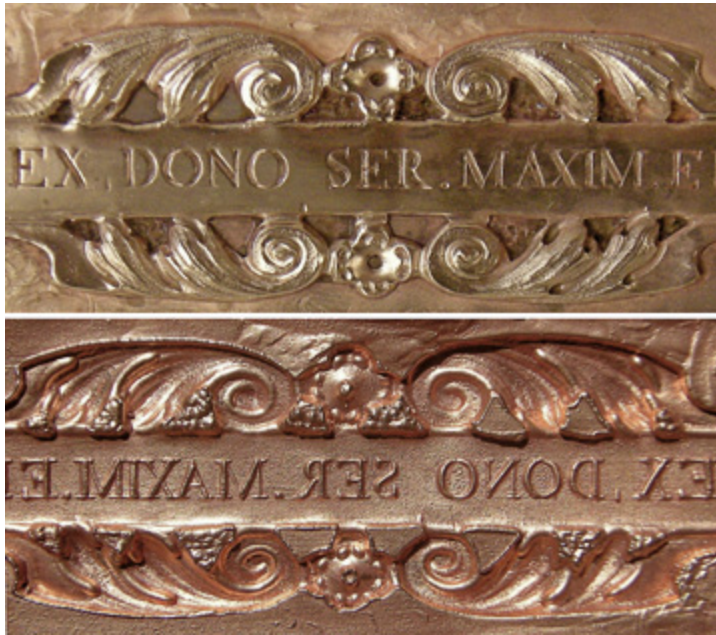
Abb. 5: Beispiel einer Galvanoplastik aus Kupfer; auf der Vorderseite sind alle Oberflächenstrukturen des Originals abgeformt; auf der Rückseite ist im unbearbeiteten Zustand der typisch knorpelige Zuwachs zu erkennen.
