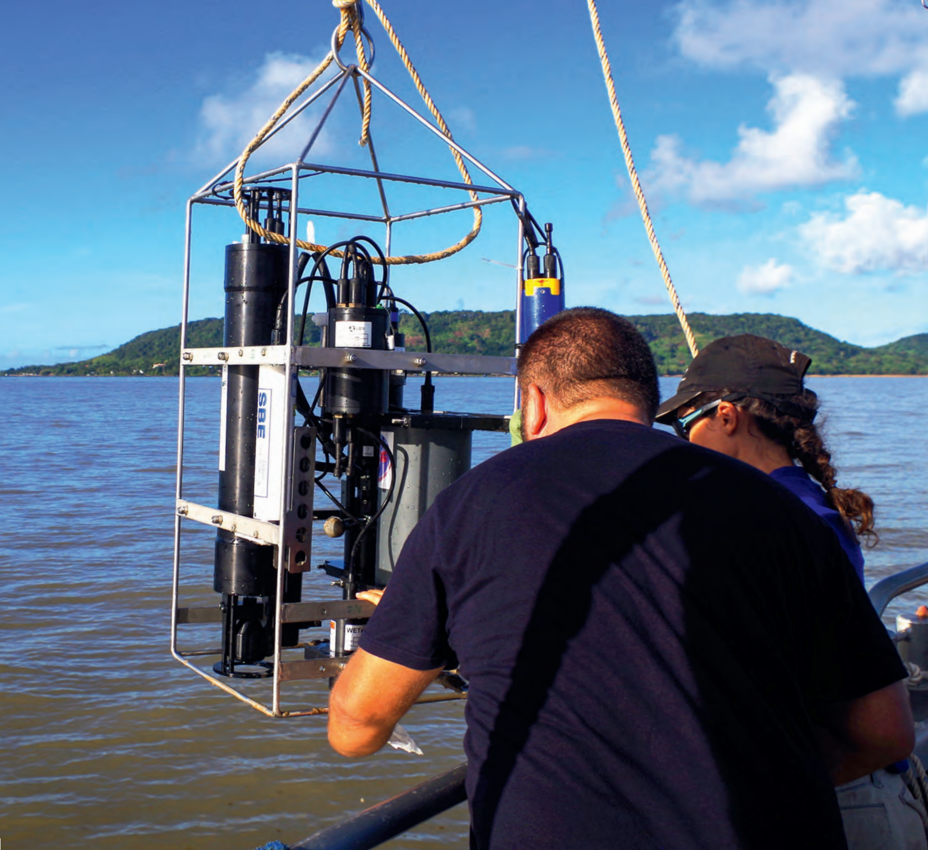
Mesures des propriétés optiques des eaux côtières qui seront utilisées pour calibrer les observations des satellites.
