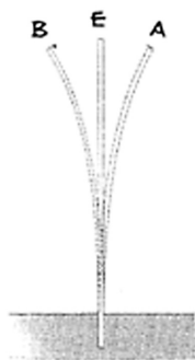
Fig. 1. Oscillazione completa che compie la laminetta (da A verso B e da B verso A), passando dal punto di equilibrio E
