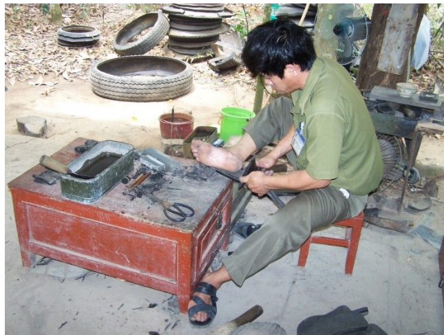
In het museum in Cu Chi demonstreert een handwerksman hoe uit rubberbanden sandalen werden vervaardigd door opstandelingen
