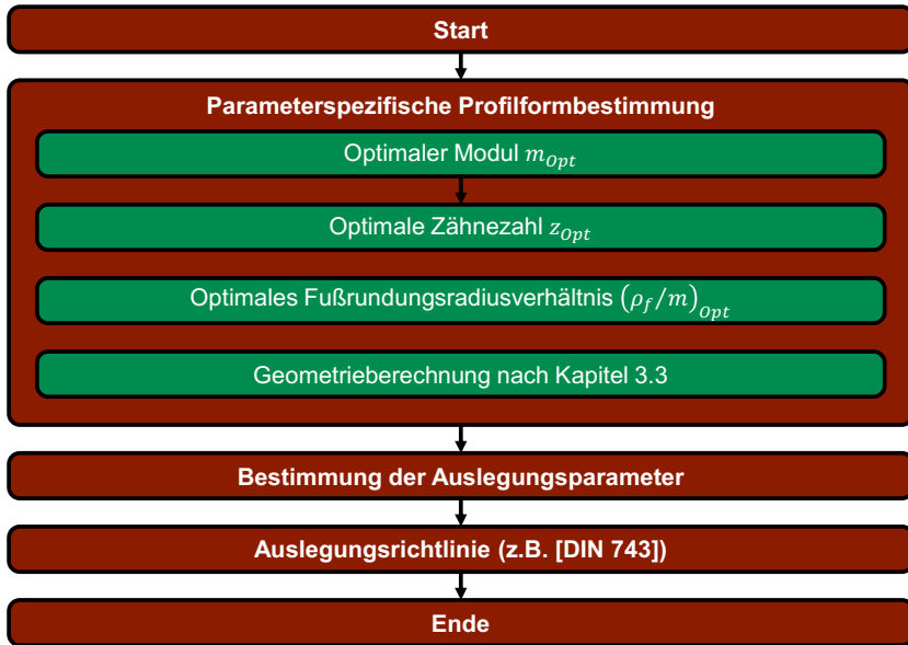
Abbildung 6.152: Bestandteile zur parameterspezifischen Profilformbestimmung der Routine zur optimalen Gestaltung und Auslegung evolventisch basierter ZWV nach Kapitel 3.3 gemäß Tabelle 6.1
