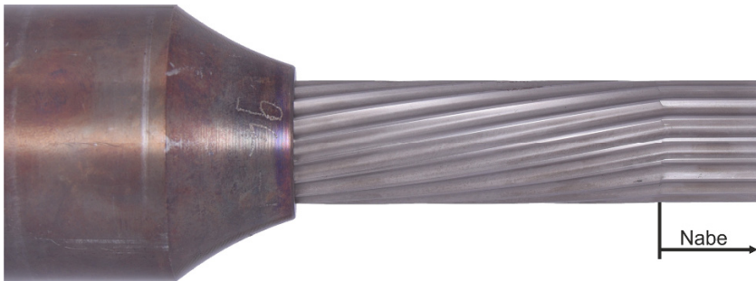
Abbildung 11.470: Repräsentatives Schadensbild nach einem maximalen Torsionsmoment M_t von 1.950 Nm (Statische Torsion, ZW Kapitel 3.3 – W 25 x 1,25 x 18 (42CrMo4+QT) nach Abbildung 11.467, ZN [DIN 5480] – N 25 x 1,25 x 18 (modifiziert) (42CrMo4+QT) nach Abbildung 11.466 sowie Abbildung 11.468)
