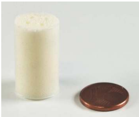
(a) Polyurethan Schaumstoffmatrix nach Dohmen et al. (2014)
