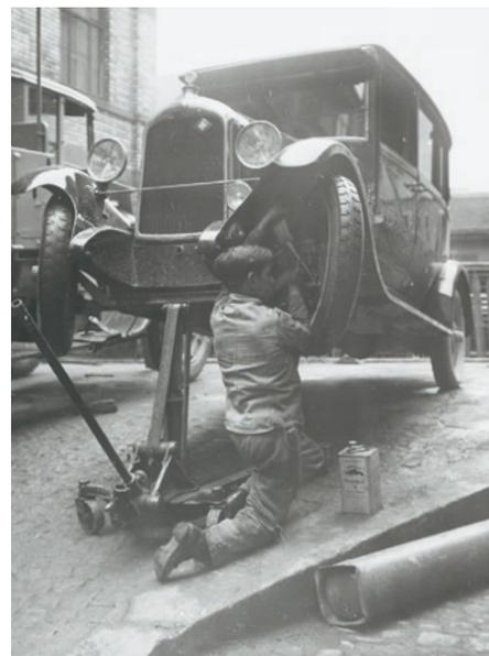
Abbildungen 95 und 96: Intensive Wartung – Reinigen und Ölen eines Automobils. Links ist der Strassenstaub zu erkennen, der sich nach einer Fahrt festsetzte.<sup>1301</sup>
