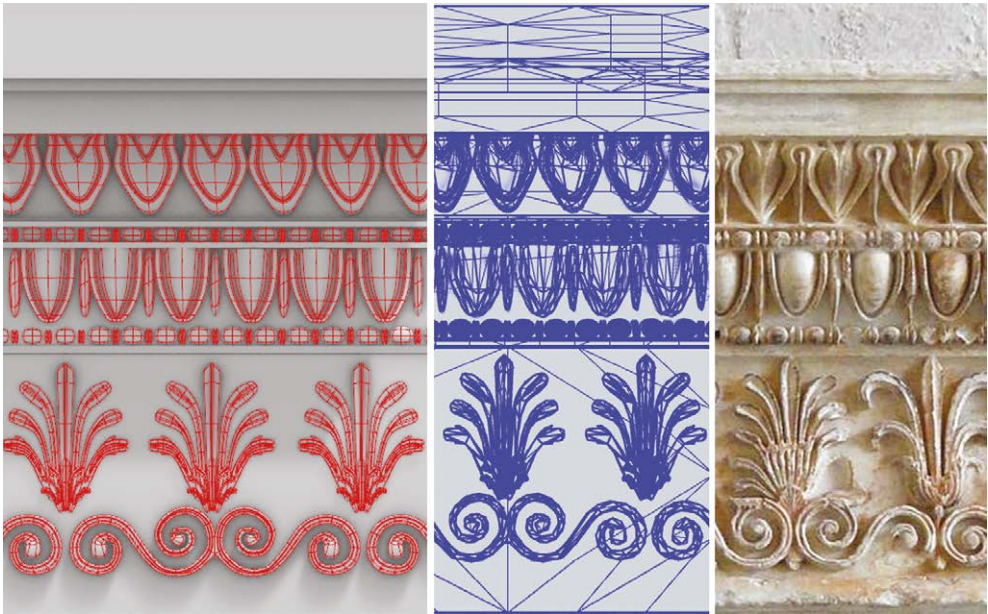
Fig. 2/ Approcci alla modellazione: a sinistra, costruzione mediante superfici di suddivisione; al centro, costruzione mediante superfici mesh; a destra, fotogramma dell'oggetto reale.
