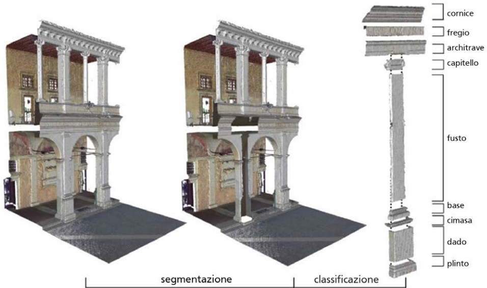
Fig. 1/ Chiostro della chiesa di S. Maria della Pace. Processo di scomposizione del manufatto nelle sue componenti costruttive elementari.
