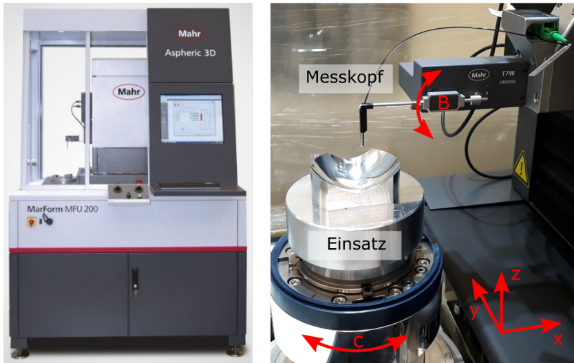
Abbildung 3.19: Links: In dem Projekt verwendete Messmaschine Mahr MFU200 [77]. Rechts: Werkzeugeinsatz auf Messmaschine [61].
